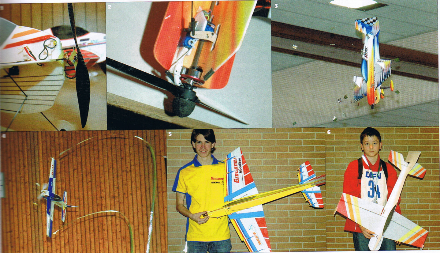
1 Carbonpropeller ermöglichen aufgrund niedriger rotierender Massen ein verbessertes Hochlaufen des Motors und damit eine präzise Gasdosierung. Hier das Exemplar von Derk van der Vecht aus dem Hause WES-Technik. 2 Das Verstellpropellersystem von Martin Müller zeichnet sich durch leichte Montage auf handelsübliche Motoren und eine wirksame Entkopplung der Krafteinleitung in das Verstellservo aus. Erhältlich bei MaMo, www.lipoly.com . 3 Der Altmeister Martin Müller zog noch mal alle Register seines Könnens. Hier der Ausstoß von Konfetti im Aero-Musicals. Am Ende wurde er Vize-Meister. 4 Benoit Dierickx im Aero-Musicals: Die Bänder zeigen gut die Dynamik des Vortrages des Belgiers. 5 Sieger in F3P-A wurde Gernot Bruckmann mit seinem Modell „Spark“. 6 Sieger in F3P-B wurde Marek Plichta mit seinem Modell „Predator“.
